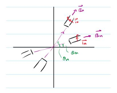
$$\vec{B_s} = \begin{bmatrix} e^{j\theta_m} & e^{j\theta_n} \end{bmatrix} \begin{bmatrix} B_{sm} \\ B_{sn} \end{bmatrix}$$
